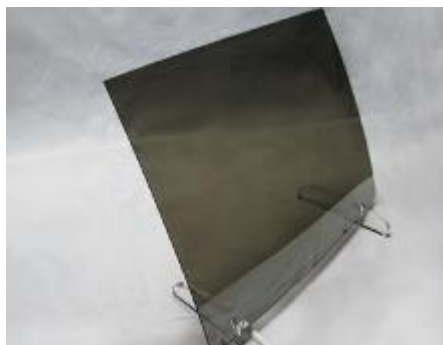
Fig.9.3.非軟化曲げ加工によるハーフミラー板
